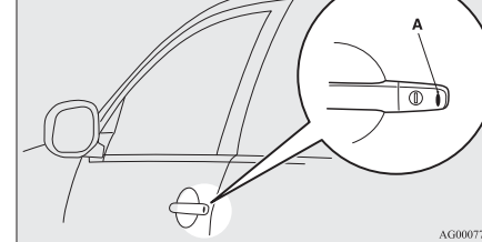
Lås-/upplåsningsknappar för förardörren och passagerardörren
